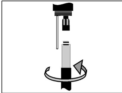
6 Die Einheit bis zum Anschlag in den Sensor schieben.
