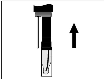
7 Die KCl-gefüllte Kunststoffkappe zum Messen von der Einstabmesskette abziehen.
